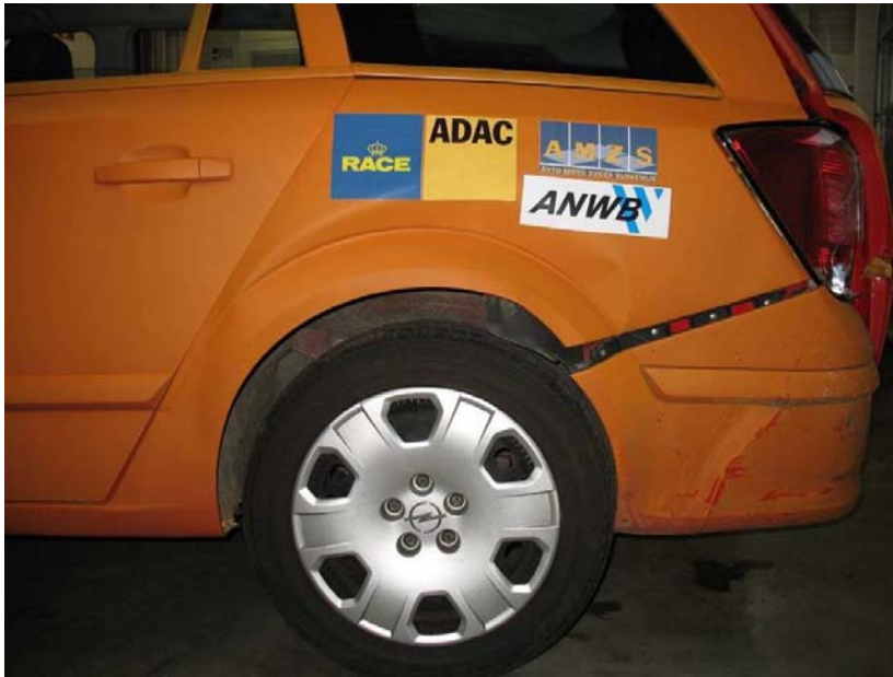
Figura 5: vista lateral del Astra deformado.
